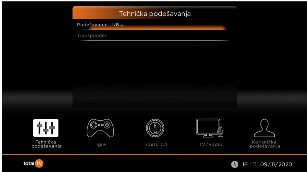
U podmeniju **Podešavanje LNB-a** moguće je izabrati željeni Satelit i povezati ga sa LNB-om (DiSEqC Port). Pored toga može se podesiti Tip LNB-a kao i opseg frekvencija na satelitu.
