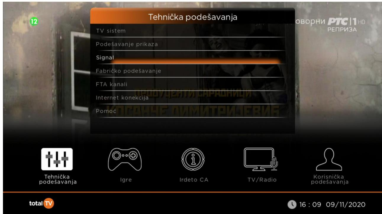
U podmeniju **Signal** može se proveriti SN ratio (Odnos Signal-Šum), BER (Bit Error Rate), Jačinu i kvalitet signala, kao i da li ima prekida u istom.
